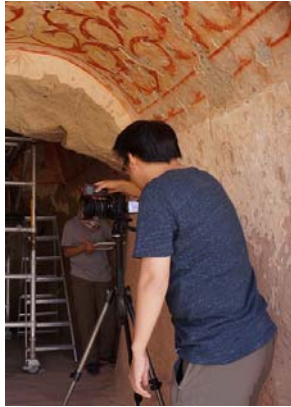
図 3. カメラから撮影面 までの距離計測
